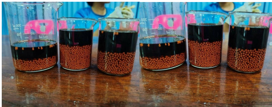
ภาพที่ 9 ภาพเปรียบเทียบความแตกต่างทางกายภาพของแคปซูล "สูตรที่ 1 (เป็นแผ่นติดกัน)" กับ "สูตรที่ 6 (เป็นเม็ดกลมร่วนสวยงาม)"
