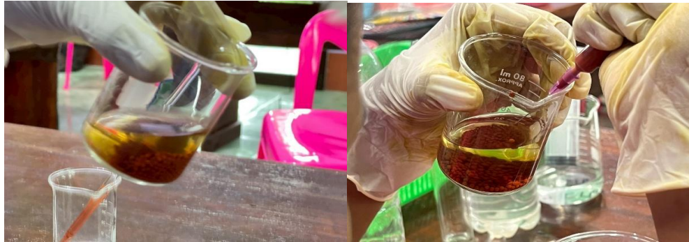
ภาพที่ 8 ภาพการใช้หัวเข็มเบอร์ 24G หยดสารละลาย (กระบวนการ Ionotropic Gelation)
