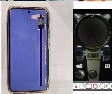
ภาพที่ 10 หน้าจอสมาร์ทโฟนที่นักเรียนใช้แอปพลิเคชัน Vernier Caliper และ Magnifier & Microscope ตรวจวัด ขนาดแคปซูลระดับไมโครเมตร (152.4 ไมโครเมตร)
