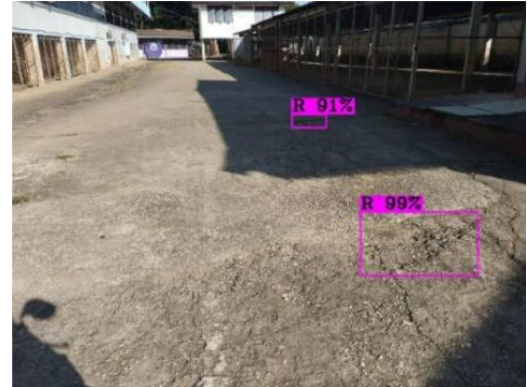
ภาพที่ 2 ตัวอย่างรูปที่ส่งข้อมูลมาใน Telegram
