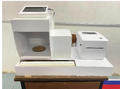
ภาพที่ 1 เครื่องคัดแยกเกรดเนื้อโคขุนโพยอย่างคำที่พัฒนามาเพื่อให้สามารถคัดแยกเกรด น้ำหนัก และราคาของเนื้อ ได้ภายในเครื่องเดียว
