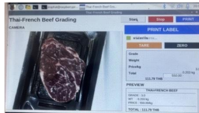
ภาพที่ 2 หน้าจอแสดงผลเกรด น้ำหนัก ราคา และบอกราคาต่อกิโลกรัมของตัวเนื้อ
