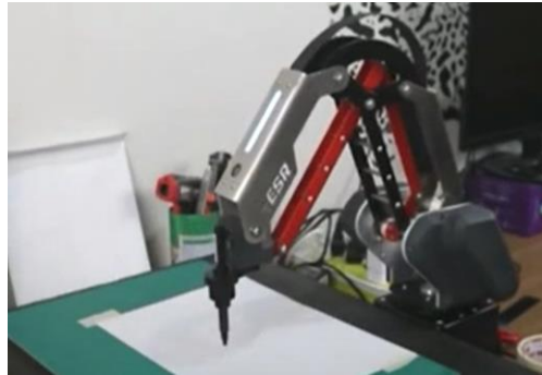
รูปที่ 4 หุ่นยนต์แขนกลที่สร้างเสร็จแล้ว
