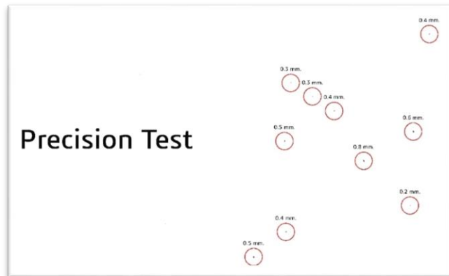
(ข) ผลการทดสอบความคลาดเคลื่อนของหุ่นยนต์แขนกล
