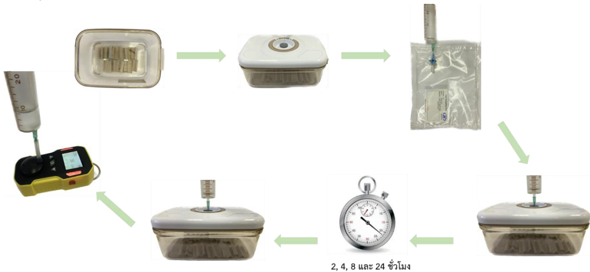
รูปที่ 1 แผนภาพกระบวนการทดสอบความสามารถในการดูดแก๊สเอทีลินของตัวอย่างกระดาษชีวภาพ
